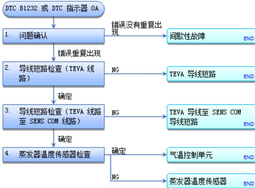
**DTC B1232 或 DTC 指示器 0A:** 蒸发器温度传感器电路短路
